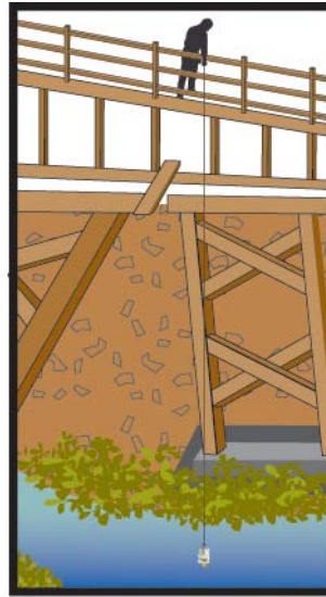
Figure 4. Sampling from a bridge (Ministère de l'Environnement, Gouvernement du Québec (2000))
